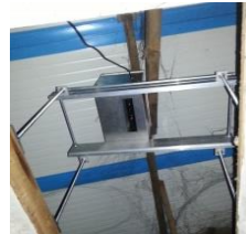
Abb. 5: 3D-Sensor xTion in einem Schutzgehäuse
