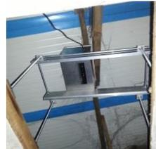
**Abb. 5:** 3D-Sensor xTion in einem Schutzgehäuse
